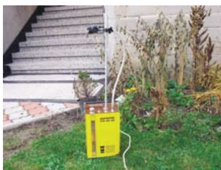
Rys. 8. Aspirator typu AS-50 służący do pobierania próbek powietrza w środowisku
